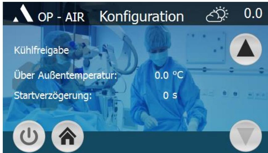
Hier erfolgt die Freigabe der Kältemaschine bzw. Kühlanforderung in Abhängigkeit der Außentemperatur.
