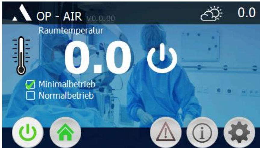
Die Anlage arbeitet im Minimalbetrieb. Hintergrund ist die Vermeidung von „stehender Luft“ im Lüftungsgerät, welches Keimwachstum begünstigen kann. In diesem Modus läuft der Ventilator mit stark reduzierter Drehzahl, der Heizbetrieb ist aktiv, der Kühlbetrieb ist gesperrt. Die Einstellung des Sollwertes für die Luftmenge „Minimalbetrieb“ (Gundlast) erfolgt in der Parameterebene.
