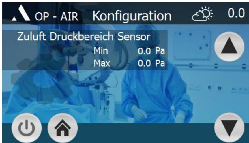
Der Druckbereich für den Analogeingang muss zu dem Ausgangssignal des Ziehl-Abegg Drucktransmitter (ist am TB3 montiert) passen und ist auf 0-3.000 Pa einzustellen.
