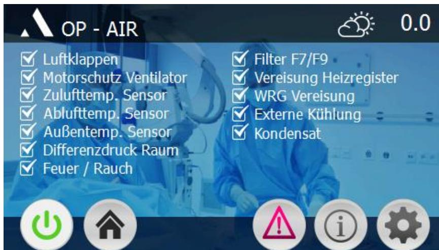
Hier werden alle Digitaleingänge sowie die Analogeingänge für die Fühler des Reglers abgebildet. Es wird grundsätzlich zwischen leichten und schweren Fehlern unterschieden.
