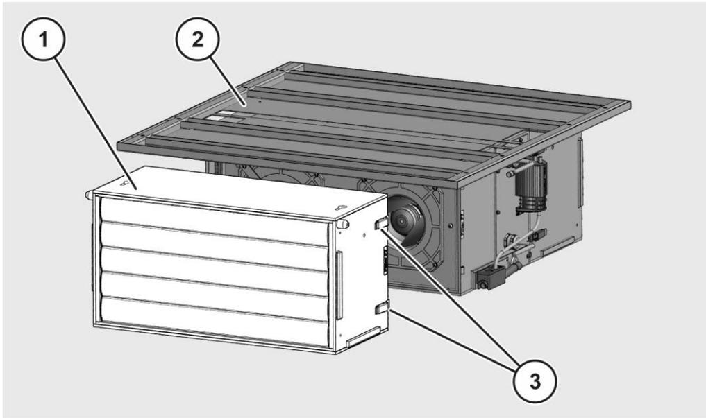
Um das Filtergehäuse zu montieren, gehen Sie wie folgt vor:
