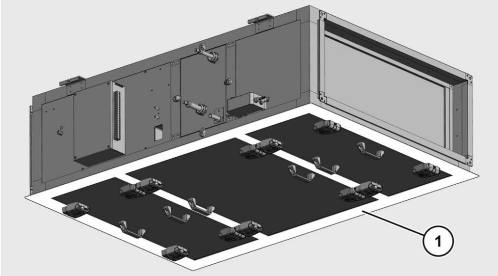
Die Blende (1) ragt an allen Seiten 25 mm über die Außenkontur des Geräts hinaus und überdeckt den mit der Raumdecke entstehenden Stoß. Der Hepa Jet TB3 light wird in Kombination mit der Blende grundsätzlich mit einem schmalen (300 mm) und nach oben versetzten Kanalstutzen (3) geliefert. Dadurch entsteht ein erweiterter Arbeitsraum (2) für den Trockenbauer.
