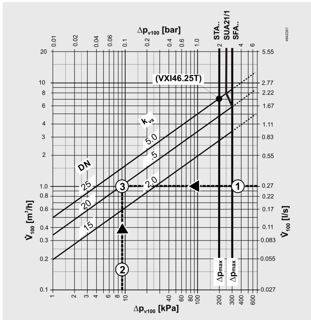
$\Delta p_{v100}$  Differenzdruck über dem voll geöffneten Ventil und dem Regelpfad A → AB bei Volumendurchfluss  $\dot{V}_{100}$
