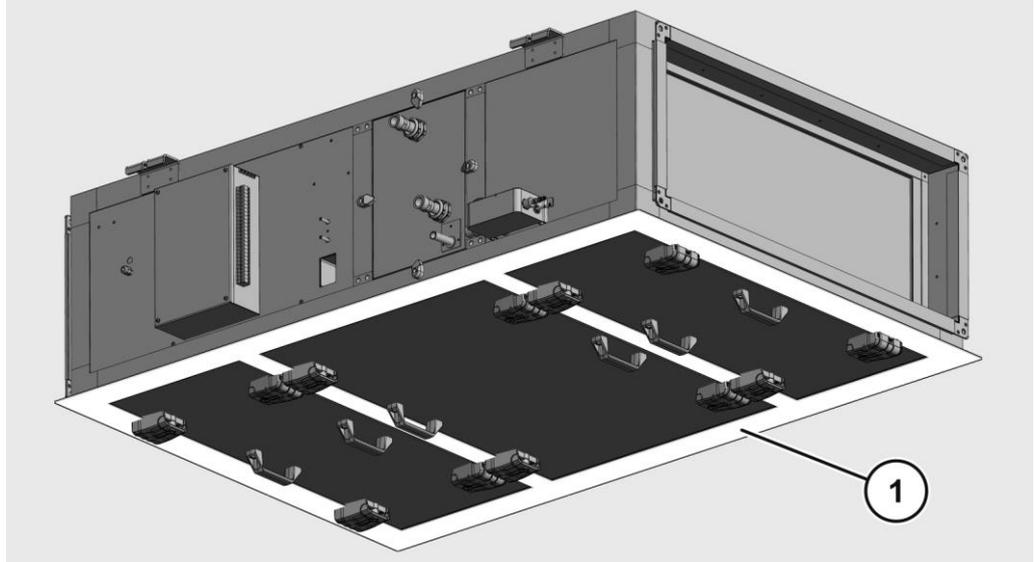
Die Blende (1) ragt an allen Seiten 25 mm über die Außenkontur des Geräts hinaus und überdeckt den mit der Raumdecke entstehenden Stoß. Der Hepa Jet TB3 light wird in Kombination mit der Blende grundsätzlich mit einem schmaleren (300 mm) und nach oben versetzten Kanalstutzen (3) geliefert. Dadurch entsteht ein erweiterter Arbeitsraum (2) für den Trockenbauer.
