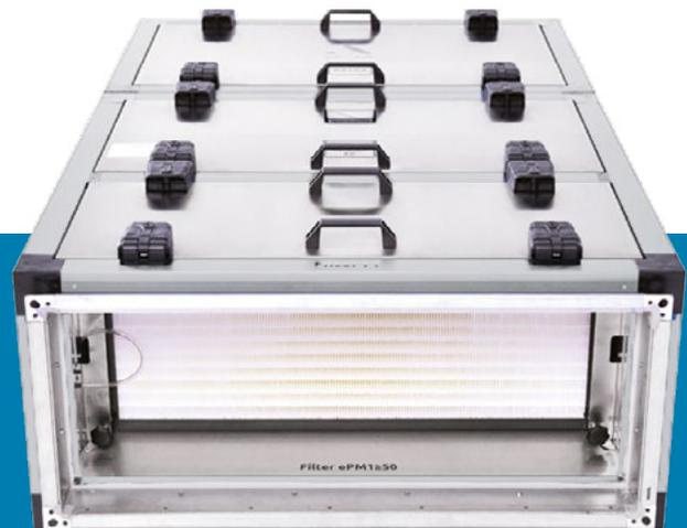
Die Gehäuse bestehen aus einer Konstruktion aus eloxierten Strangpressprofilen, welche untereinander durch eingelassene Kunststoffbarrieren thermisch voll entkoppelt sind. Die unten befestigten Revisionsklappen und die Seitenwände können leicht entfernt werden. Die Elemente aus gebürstetem Edelstahl entsprechen der DIN 1946-4.
