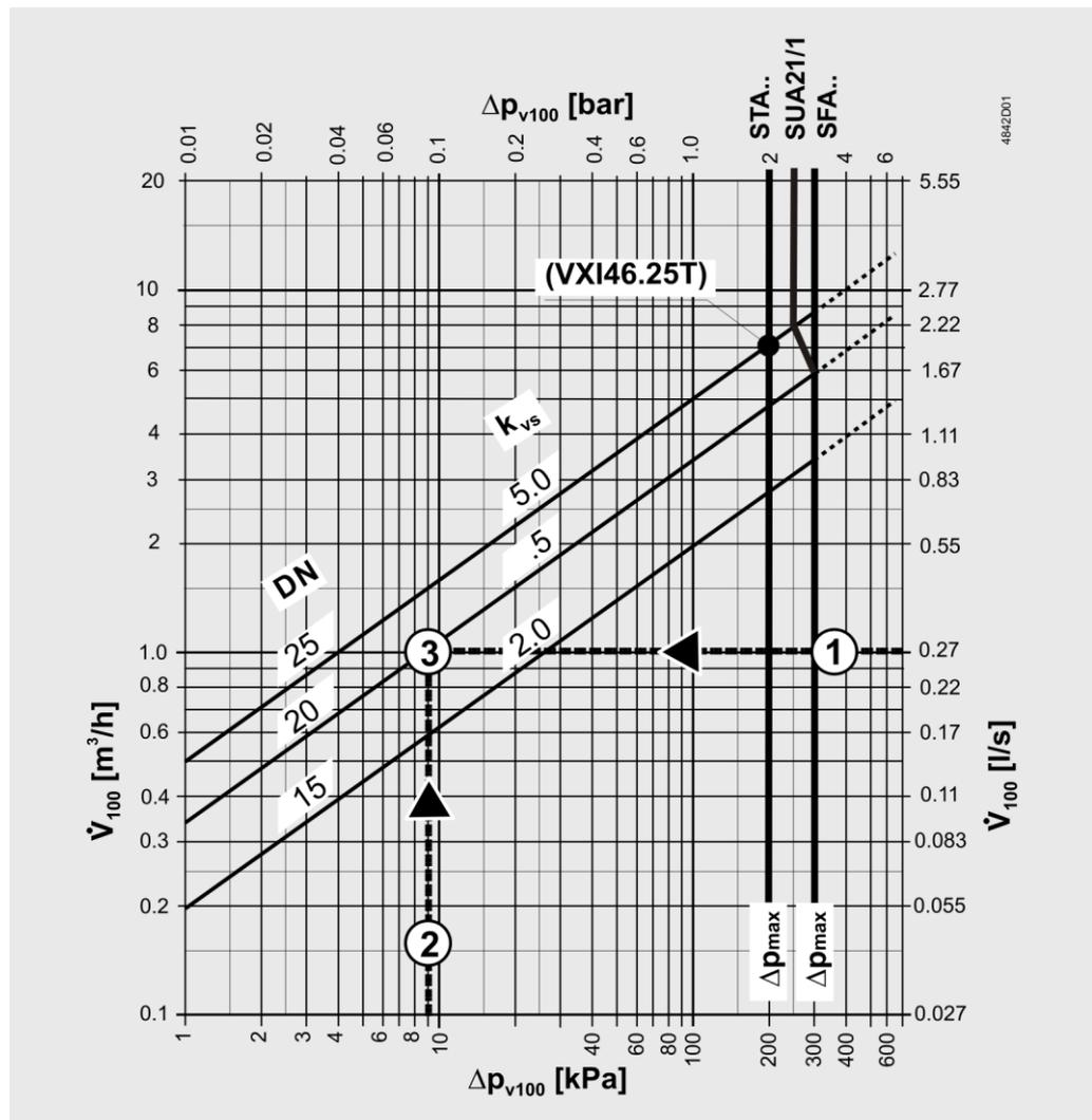
$\Delta p_{v100}$  Differenzdruck über dem voll geöffneten Ventil und dem Regelpfad A → AB bei Volumendurchfluss  $V_{100}$
