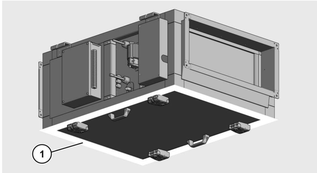
Die Blende (1) ragt an allen Seiten 25 mm über die Außenkontur des Geräts hinaus und überdeckt den mit der Raumdecke entstehenden Stoß. Durch den nach oben versetzten Kanalstutzen (3) entsteht ein erweiterter Arbeitsraum (2) für den Trockenbauer.
